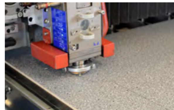
Sagomatura personalizzata del pianale con taglio al laser
