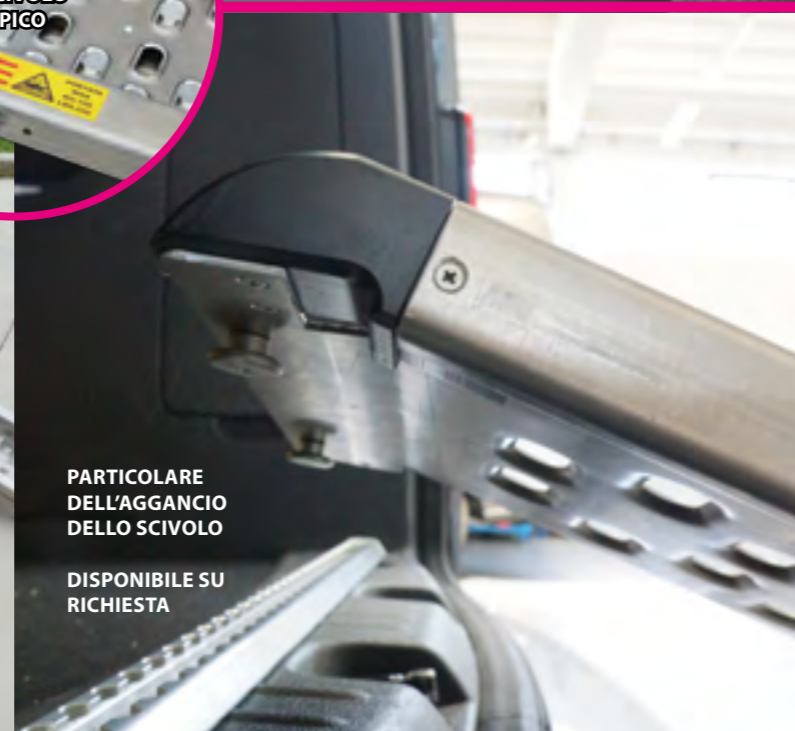
PARTICOLARE DEL BLOCCO DELLO SCIVOLO TELESCOPICO
